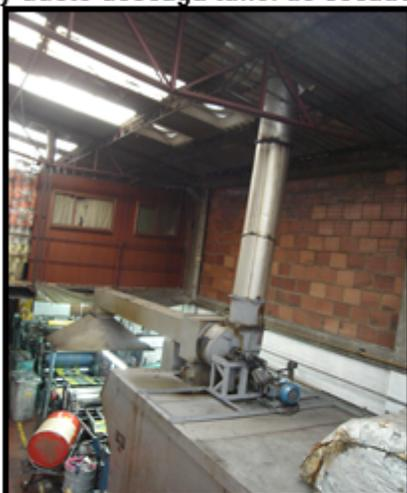
**Foto 10. Ducto de descarga de emisiones tunel de secado (final)**
